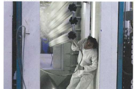
Eigene Pulverbeschichtungsanlage für noch pflegeleichtere Oberflächen
